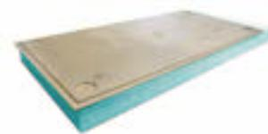
Pannello in polistirene densità 15÷35 kg/m<sup>3</sup> | Conduttività termica dichiarata  $\lambda_D$ [W/(m\*k)] 0,026÷0,036 | Calore specifico c 1.450 J/kg K
