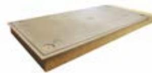
Pannello in fibra di legno densità 110 kg/m<sup>3</sup> | Conduttività termica dichiarata  $\lambda_b$ [W/(m\*k)] 0,039 | Calore specifico c 2.100 J/kg K
