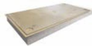
Pannello in polistirene densità 15÷35 kg/m<sup>3</sup> | Conduttività termica dichiarata  $\lambda_D$ [W/(m\*k)] 0,026÷0,036 | Calore specifico c 1.200 J/kg K
